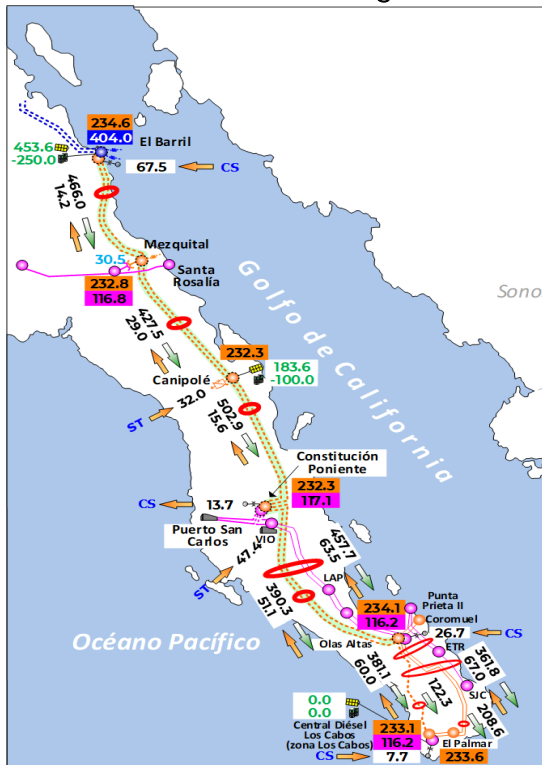
Figura 11.15 Diagrama unifilar simplificado de la Red Eléctrica de 230 kV de Mulegé a Los Cabos
