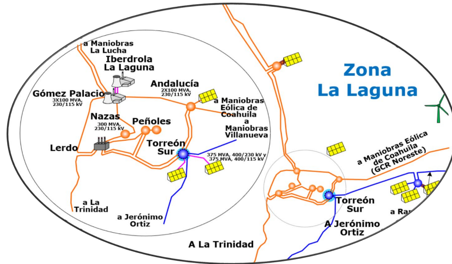
Figura 9.4.7.1. Diagrama unifilar simplificado de la Red Eléctrica de Zona de Operación Transmisión Laguna.
