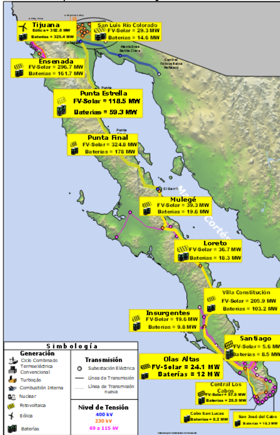
Figura 11.13 Diagrama unifilar simplificado Integración de Capacidad 2033-2037 en la península de Baja California
