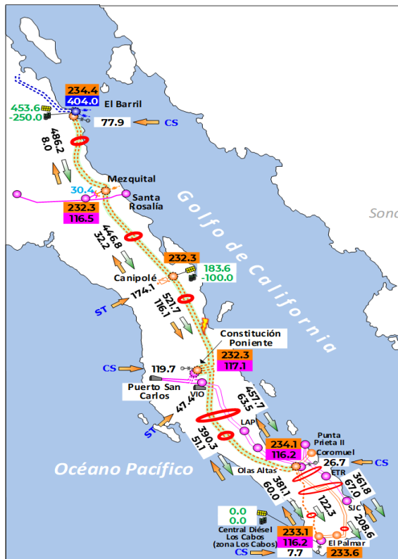
Figura 11.1.16 Diagrama unifilar simplificado salida de LT entre SE Canipolé y Constitución Poniente.
