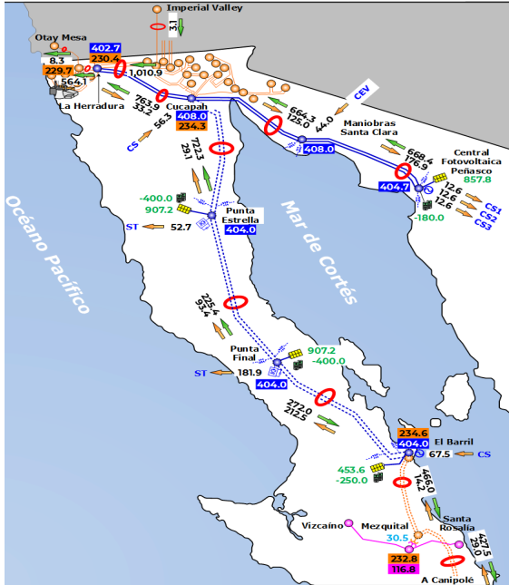
Figura 11.14 Diagrama unifilar simplificado de la Red Eléctrica de 400 kV del estado de Baja California hasta Mulegé
