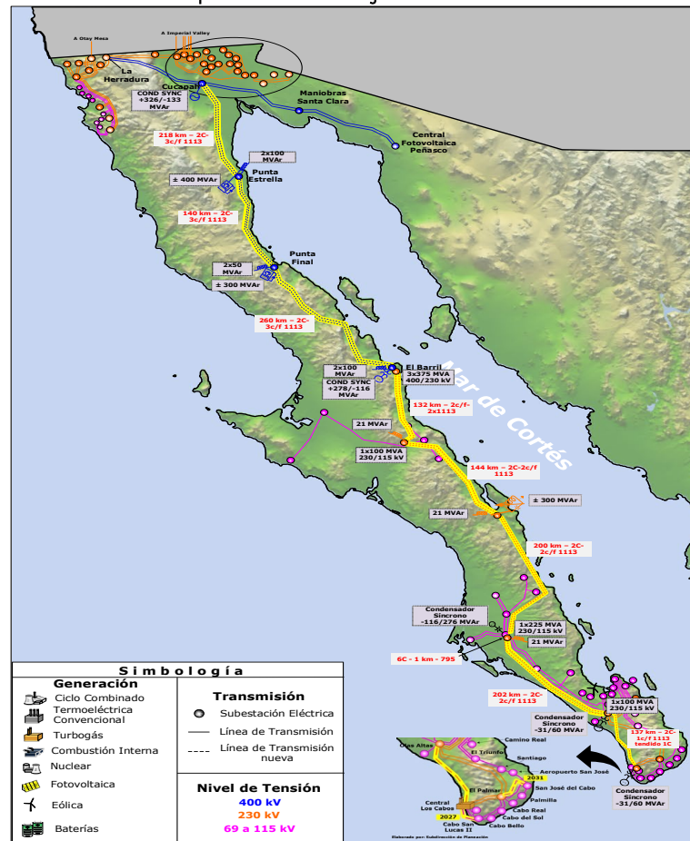
Figura 11.1.5. Diagrama unifilar simplificado, infraestructura de interconexión de los tres Sistemas de la península de Baja California 73
