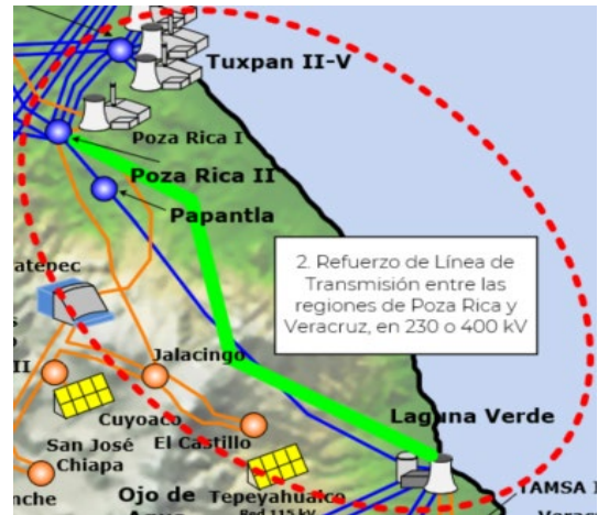
Figura 11.3.2 Diagrama unifilar simplificado del refuerzo Veracruz-Poza Rica.
