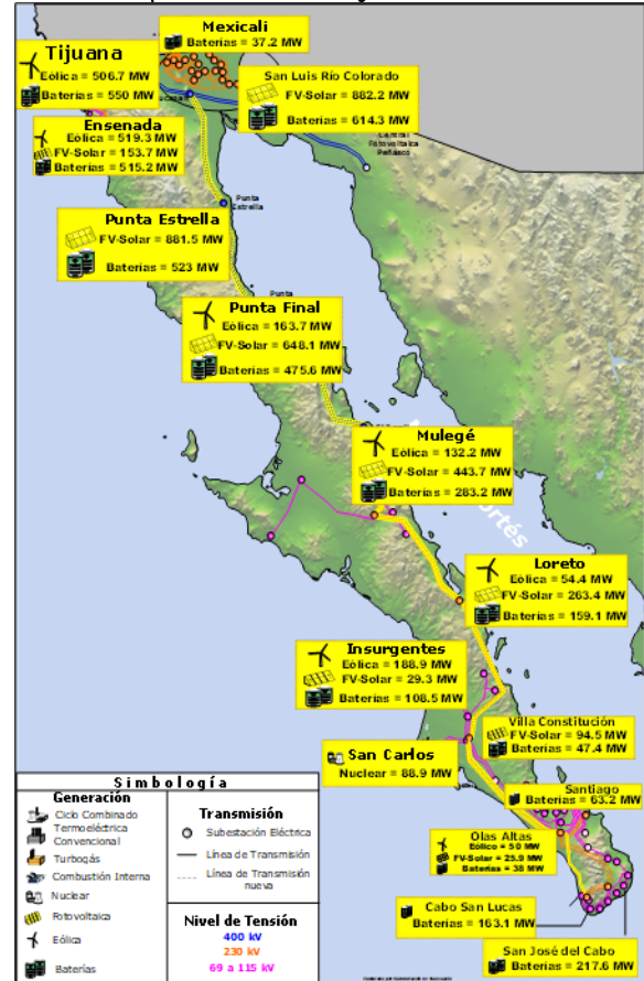
Figura 11.13 Diagrama unifilar simplificado Integración de Capacidad 2038-2050 en la península de Baja California
