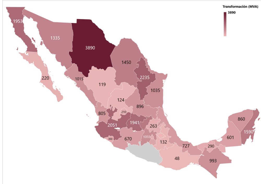
Figura 9.9.3 Capacidad (MVA) de Bancos de Transformación de la RNT totales por Entidad Federativa
