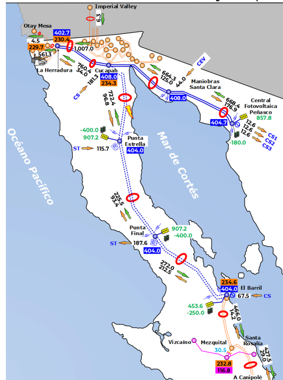
Figura 11.16 Diagrama unifilar simplificado salida de LT entre SE Punta Estrella y Cucapah.
