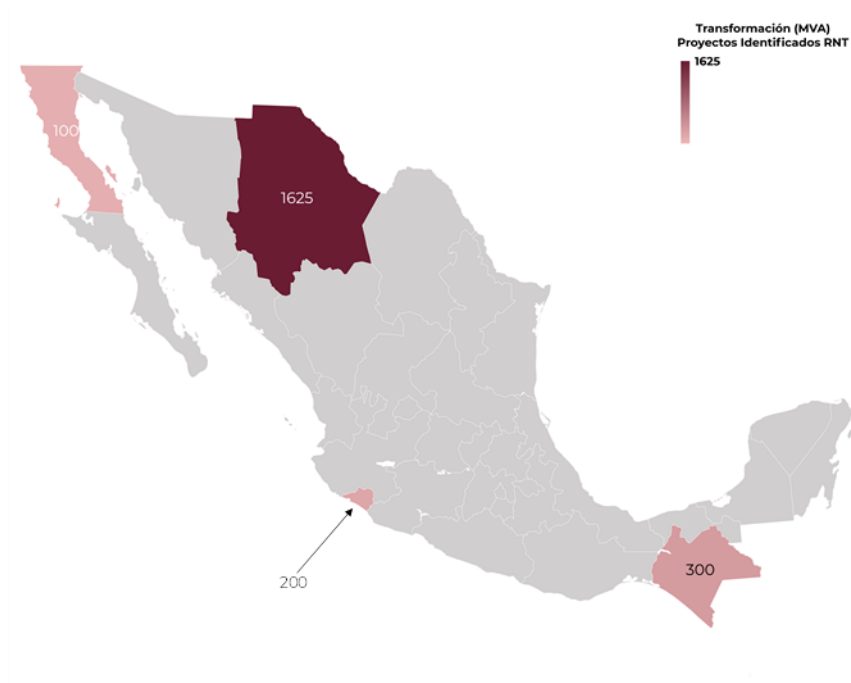
Figura 9.4.3. Capacidad (MVA) de Bancos de Transformación identificados por Entidad Federativa
