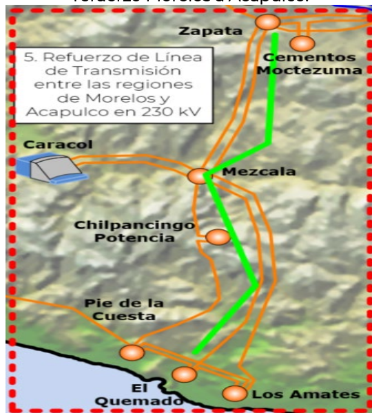
Figura 11.3.4 Diagrama unifilar simplificado del refuerzo Morelos a Acapulco.
