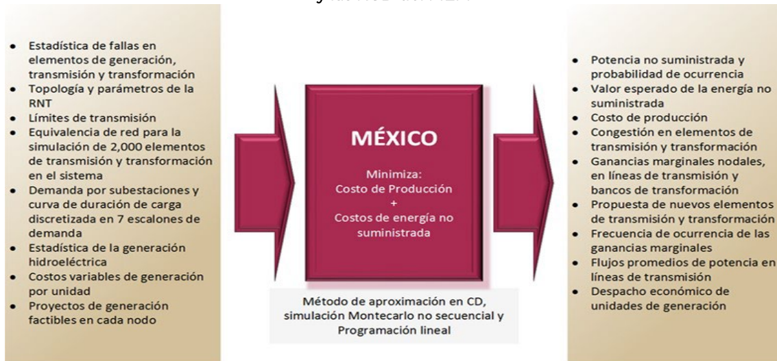
Figura 3.1.4. Proceso de estudios probabilísticos de Confiabilidad compuesta para la ampliación de la RNT y las RGD del MEM
